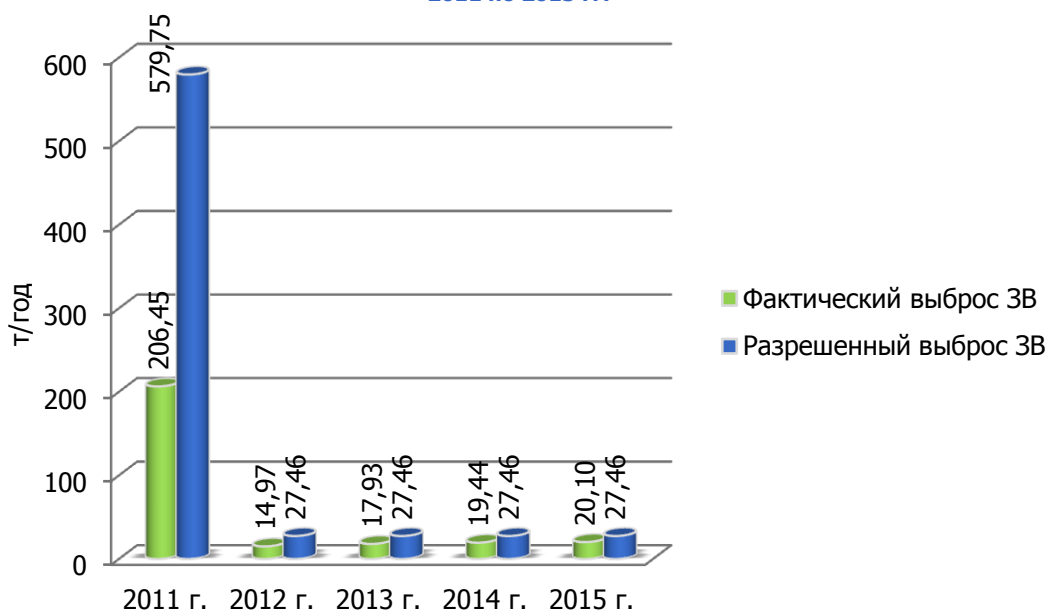
Диаграмма 6. Динамика валового выброса ВХВ в атмосферный воздух от ПАО «МСЗ» за период с 2011 по 2015 гг.
