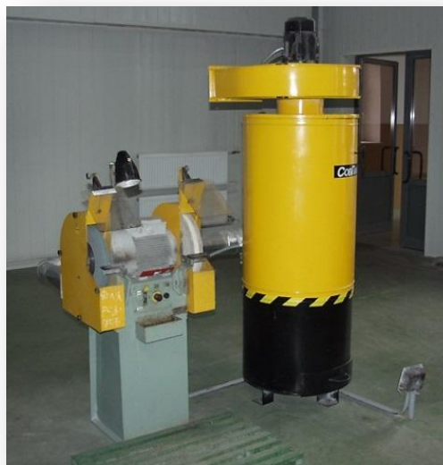
Рисунок 22. Установка очистки газа ПУ-800/SP
