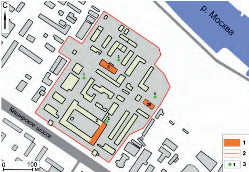
Схема наблюдательной сети филиала: 1 – контролируемые здания; 2 - территория промплощадки филиала; 3 - наблюдательная скважина и ее номер
