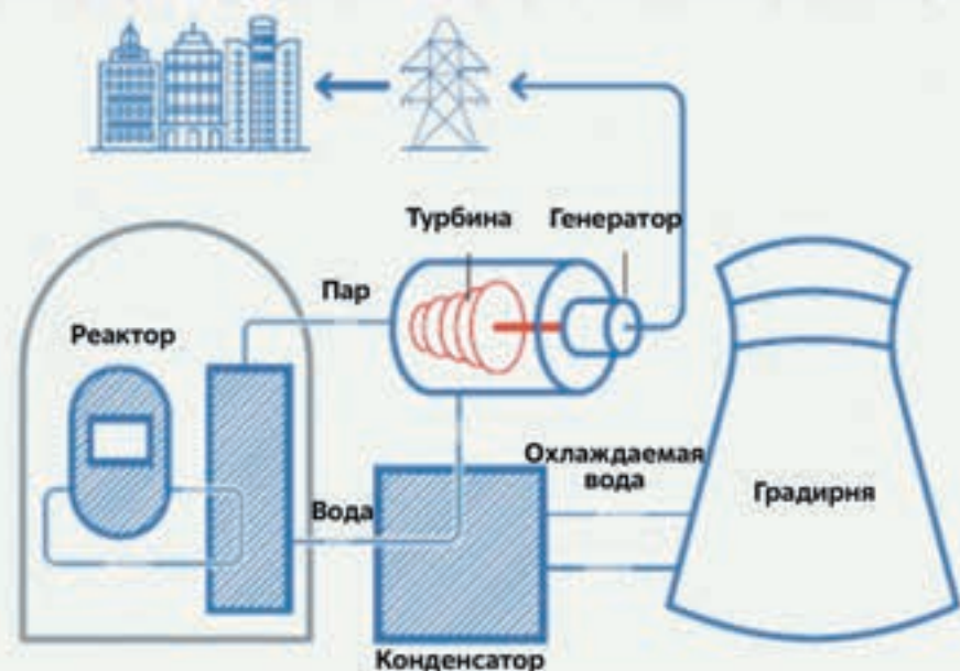
Рис. 3 — Принципиальная схема энергоблока ВВЭР-1200
