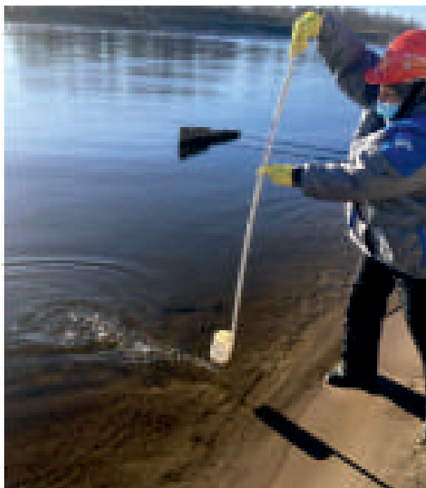
Фото 15. Пробоотбор почв, донных отложений и природных вод
