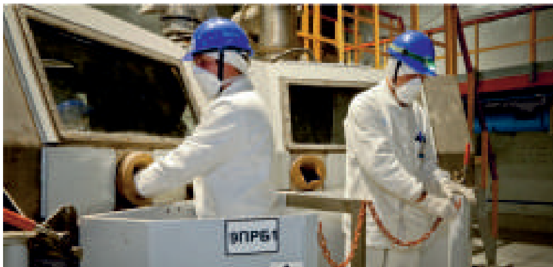
Фото 24. Установка прессования комплекса по переработке РАО
