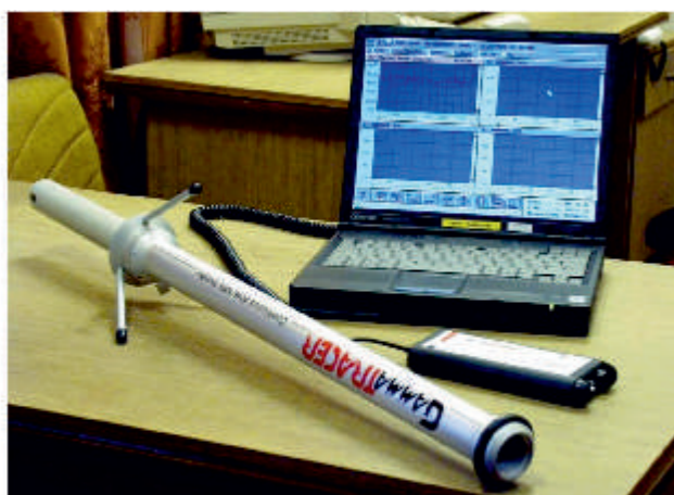
Оборудование автоматизированной системы контроля радиационной обстановки (АС КРО)
