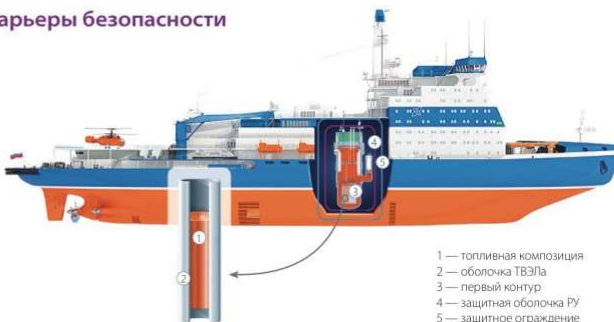
Глубокоэшелонированная защита (5 барьеров на пути распространения РАО)
