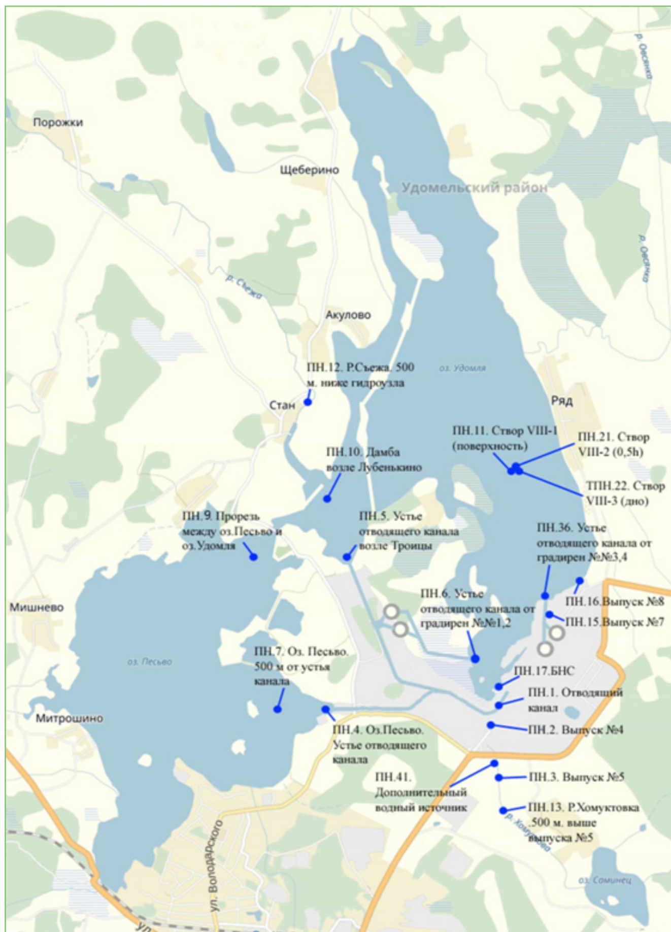
Рис. 5.4. Схема контроля гидрохимических показателей на водоеме охладителя (Водохранилище Калининской АЭС) в зоне наблюдения АЭС
