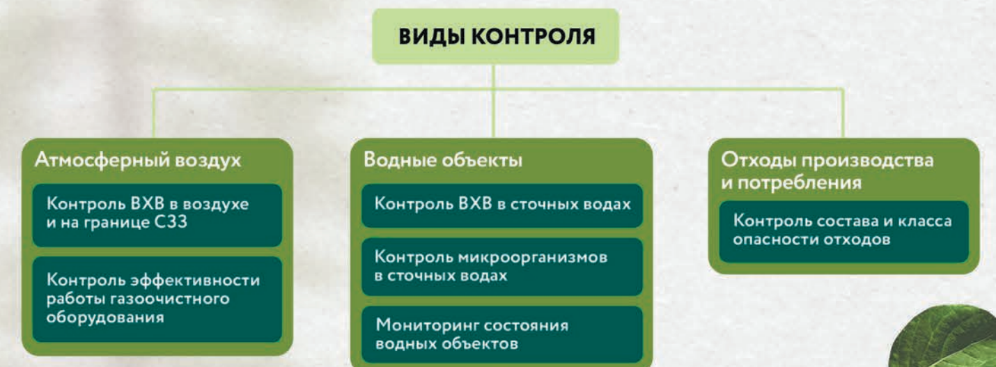
Рис. 6 – Виды производственного экологического контроля на Ленинградской АЭС
