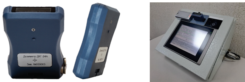
Рис. 3. Дозиметр индивидуальный ДКГ-23А и считыватель дозиметров сетевой СДС-23
